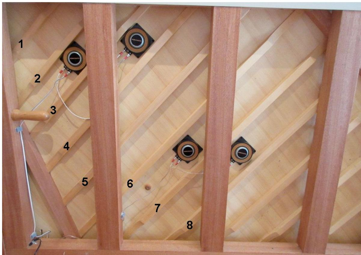
Vu de l'arrière du piano, photo ci dessus, les 2 vibreurs du canal droite se placent en haut à gauche, le premier entre la barre no 2 et no 3, le second entre la barre no 3 et no 4. Repérer l'emplacement du chevalet en vous aidant de l'axe des rosettes de table, et placer les 2 vibreurs de part et d'autre du chevalet, cela pour une meilleur transmission acoustique.
