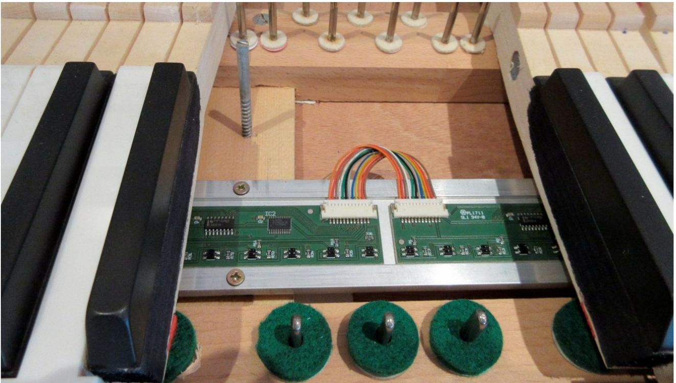
**positionnement des capteurs**
